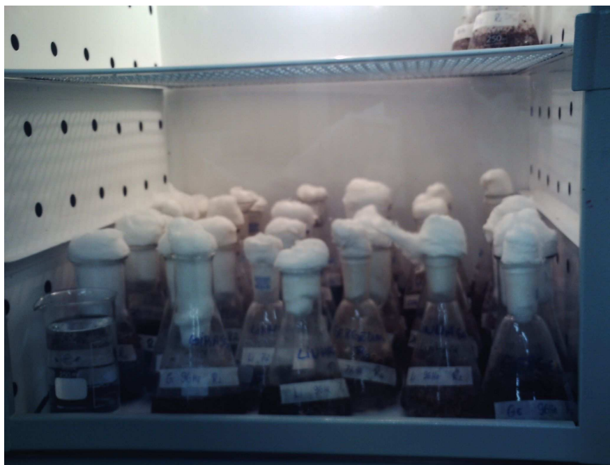
Figura 2. Sólido Fermentado incubado em estufa a 30°C. (Fotografia: Paula Condi, 2009)
