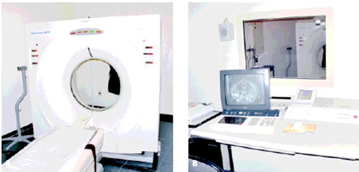
Figura 1: Aparelho de tomografia computadorizada tradicional: A) gantry e mesa, B) Computador. Fonte: GARIB et al, 2007
