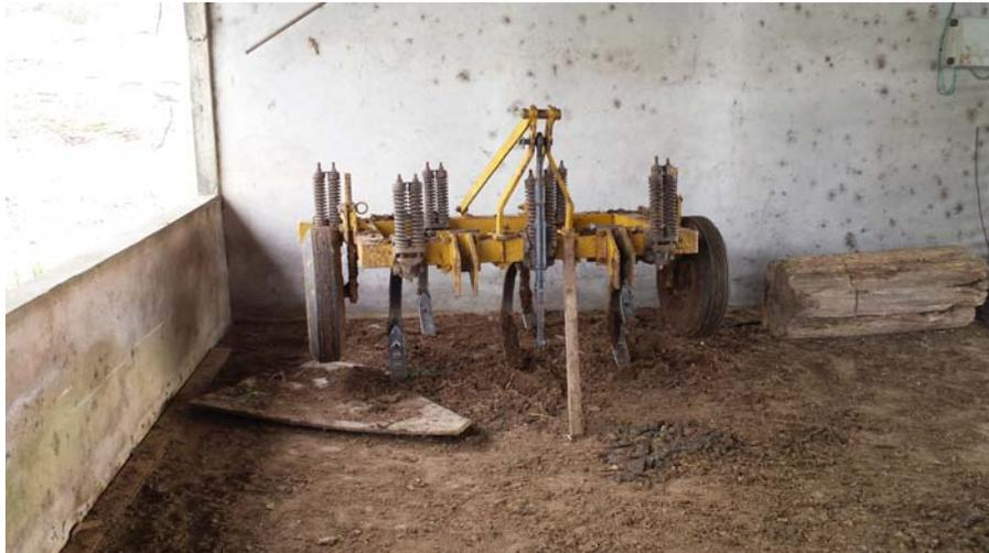
FIGURA 10: Escarificador para revolver a cama. FONTE: Acervo da Chácara Bom Retiro.
