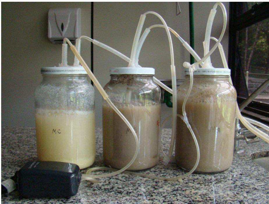
Fonte: Imagem Reator Aeróbio. Autor E.W. Delgado, 2010
