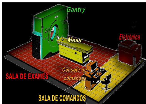
FIGURA 1. SALA DE EXAMES: Gantry, mesa. Sala de comandos: Consola de comandos, eletrônica. FONTE: LOPES (2009).
